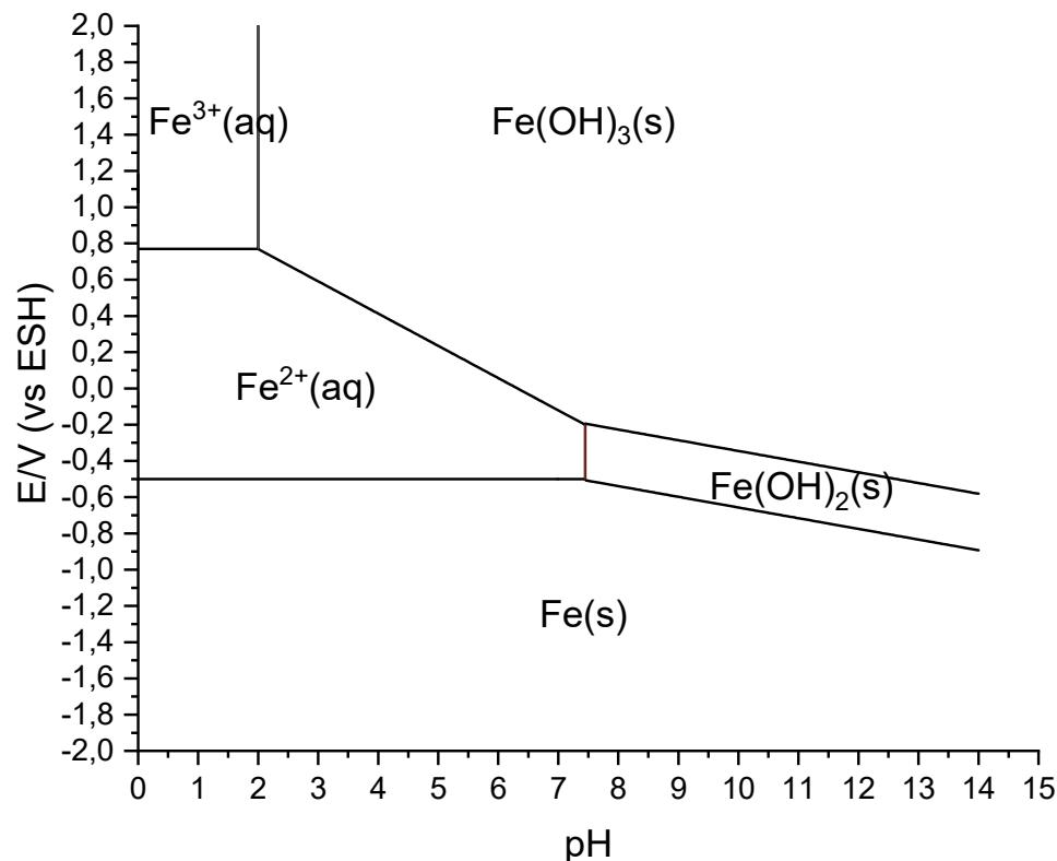
☞ Le diagramme de Pourbaix présenté a été réalisé à 25°C pour des concentrations en espèces en phase aqueuse à 0,01 M.
